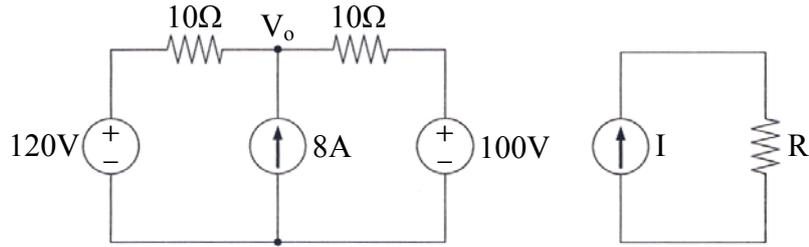
12 如圖所示電路， $R_L$  為可變電阻，試求  $R_L$  為幾歐姆時，可獲得最大功率？
